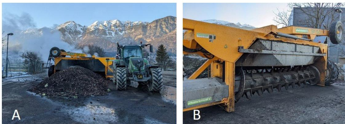
**Abbildung 28: Kompostwender im Einsatz am Pilotversuch in Hall; A: Frontalansicht B: Rückansicht**
