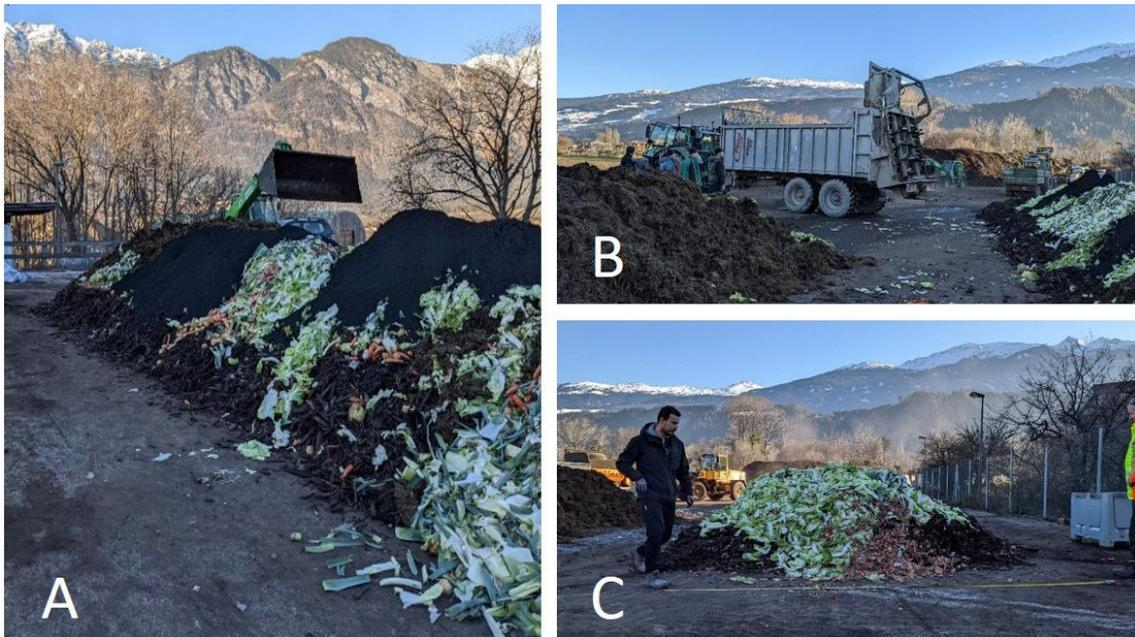
**Abbildung 27:** Kompostmietenaufbau im Jänner 2022: A: Kompostmietenaufbau mittel Radlader-Schaufel B: Anlieferung Gemüsereststoffe C: Kontrolle der geometrischen Dimensionen
