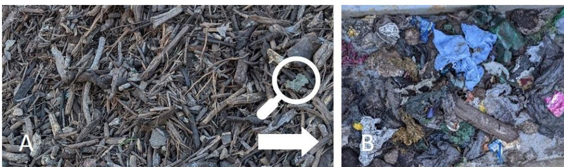
**Abbildung 30:** bereitgestelltes Strukturmaterial der Stadt Hall A: erzielte Qualität des Strukturmaterial durch Händisches Aussortieren der Fremdstoffe B: beispielhafte Darstellung der aussortierten Fremdstoffe
