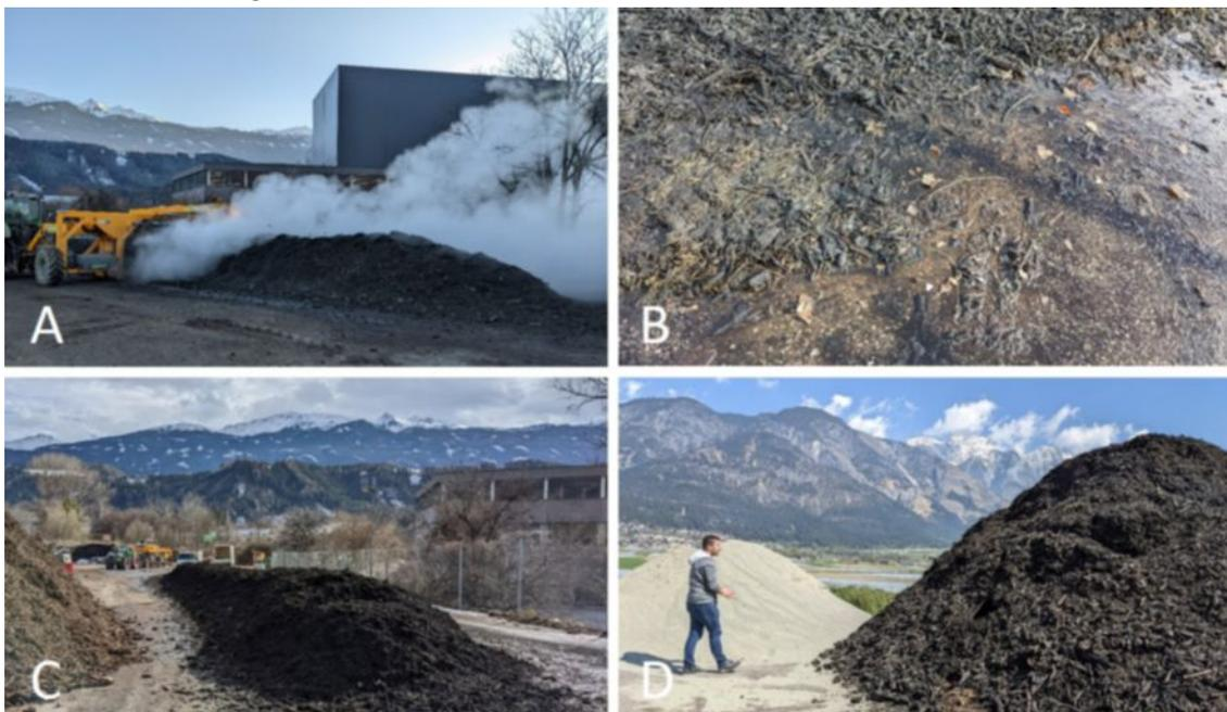
**Abbildung 29:** Rottungsverlauf des Kompostversuchs in Hall: A: Wasserdampfbildung beim Wenden als Indiz für aktive Rottephase B: Ausbleibende Wasserdampfbildung und nasse Verhältnisse werden beobachtet C: Kompostmiete unmittelbar vor dem Abbau D: Beginn der Reifephase (unausgesiebt)
